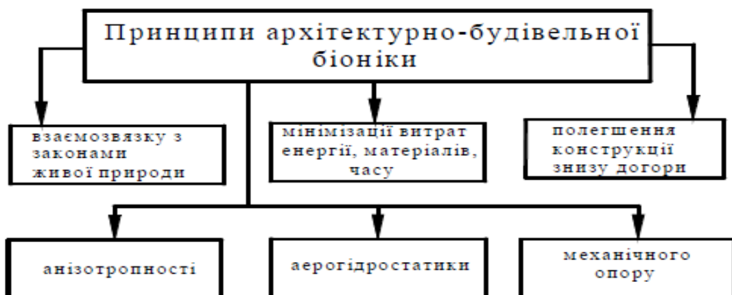
Рис. 156. Схема принципів будівельної біоніки
